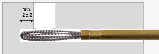
**3. Draht gekreuzt:** für Querbohrungen am Ende des Grundloches. Zum Entfernen sehr starker Grate.
